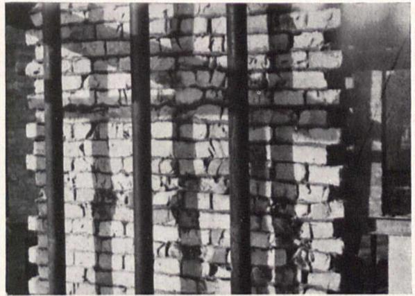
Bild 8. 3 m hoher Pfeiler aus Mauerziegeln in Novadombauweise. Belastung:  $32 \text{ kg/cm}^2$ ; Zusammendrückung 27 cm
