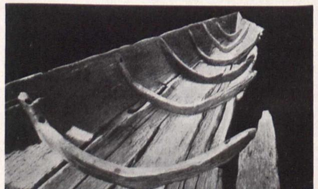
Bild 3. Einbaum aus dem Vaaler Moor mit eingebauten Krummholzspanten
