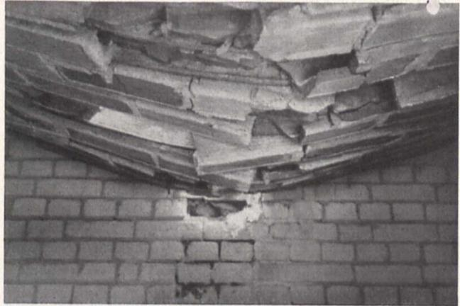
Bild 2. Untersicht einer belasteten Steineisendecke
