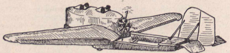
Bild 3. Bassou-Kleinflugzeug mit hinten am Flügel liegender Schraube 40/45-PS-Motor, 9,25 m Spannweite, 140 bis 165 km Geschwindigkeit
