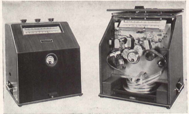
Außen- und Innenansicht des Aufnahme- und Wiedergabegeräts (Werkaufnahme)
