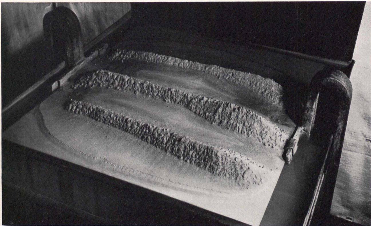
Bild 5. Landschaft mit drei Höhenrücken. — Am oberen Rand der kleinen Stufe im Vordergrund der Wasserspiegel, die Erosionsbasis Photo: Dr. Trusheim
