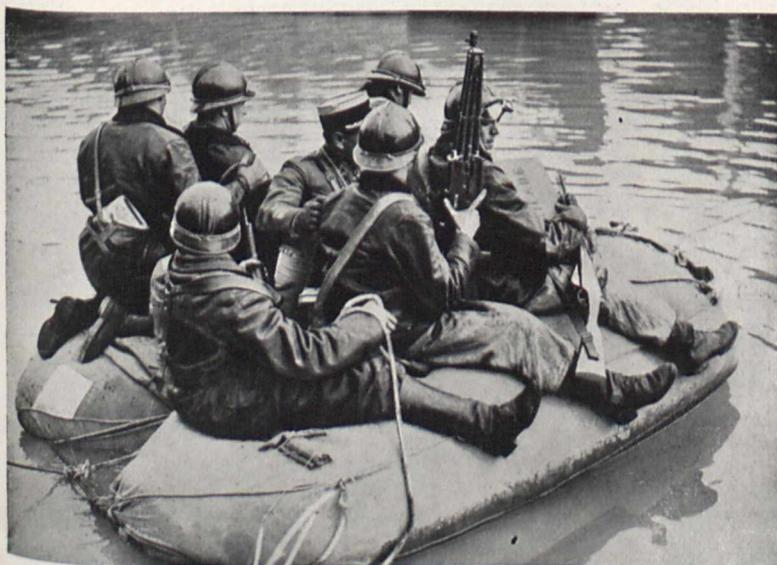
Bild 6. Die Franzosen benutzen Strohsäcke statt der Schlauchboote. — Die prall gefüllten zusammengewinkelten Strohsäcke sollen nicht untergehen
