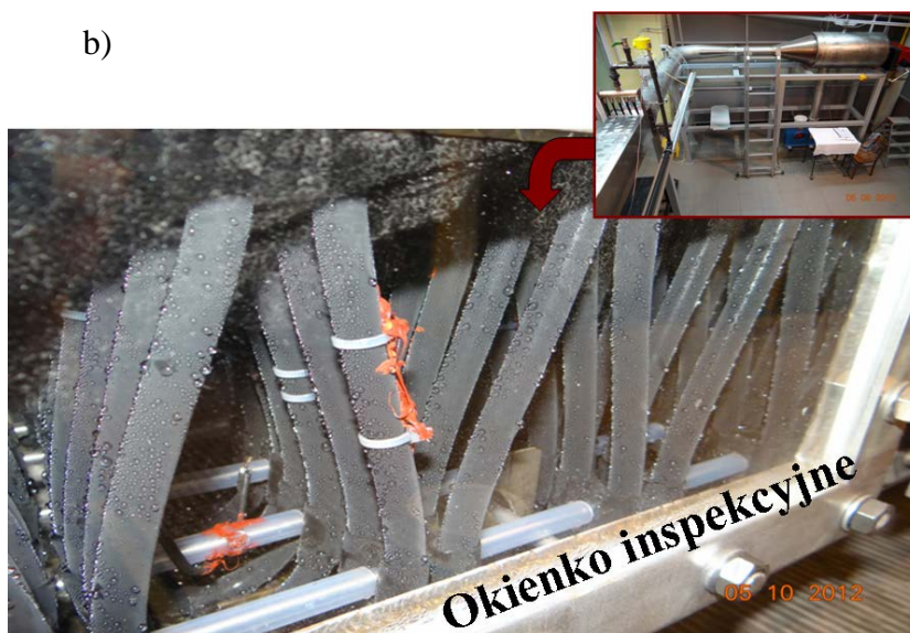
Rys. 24. Fotografia stanowiska laboratoryjnego: a – instalacja z komorą spalania po prawej, b – kondensacja na rurach wymiennika ciepła, obserwowana w okienku inspekcyjnym.
