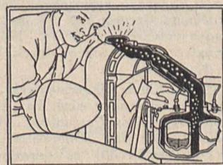
fahren, Risse in den Zylindern von Blockmotoren nachzuweisen, beschreibt „La Nature“ (2981/1936): Man füllt den Kühler ganz mit Wasser, läßt den Kühlerverschluß ungeschloßen und läßt mit der Handkurbel langsam den Motor laufen. Wenn der Kolben des beschädigten Zylinders das Gas komprimiert, werden an der Rißstelle Bläschen austreten, die durch das Kühlerwasser nach oben perlen und an der Eingußstelle herauskommen.
