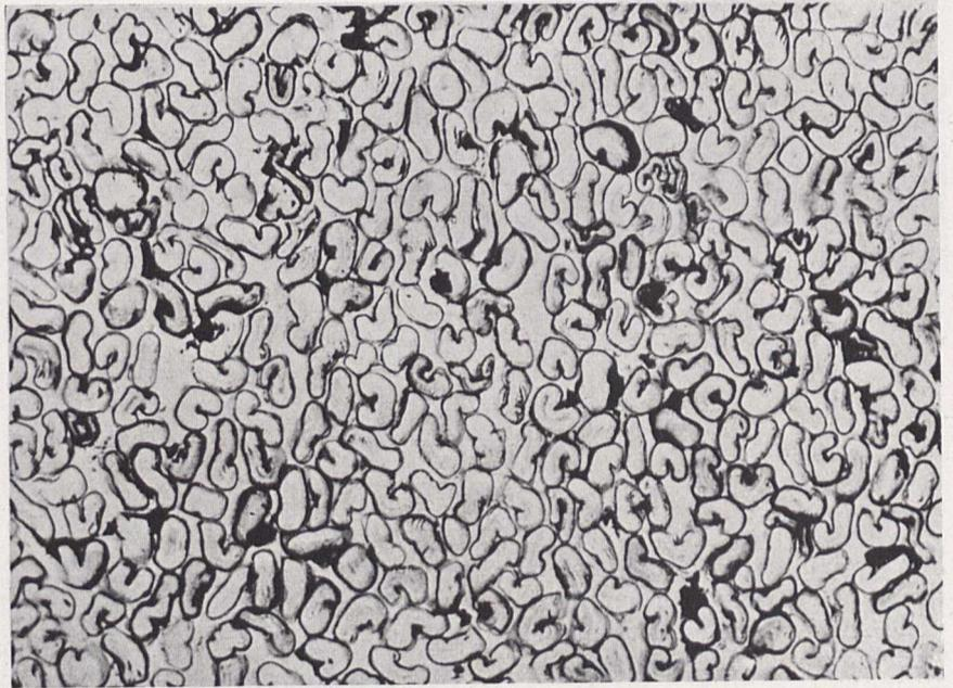
Bild 1. Querschnitt durch Baumwolle; 350fache Vergrößerung
