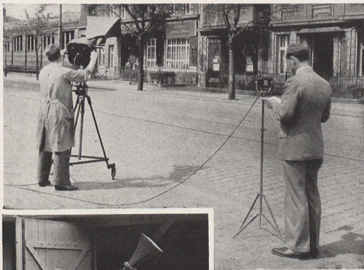
Bild 1 (links). Die Besprechung der Koffer-Lautsprecheranlage kann vom Redner vor einem fest aufgestellten Mikrophon erfolgen, während der Lautsprecher von einem Bedienungsmann nach der gewünschten Richtung gedreht werden kann
