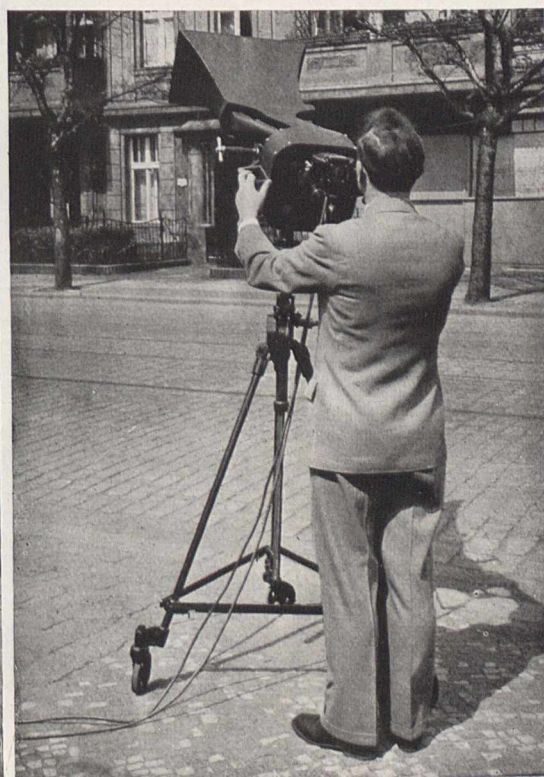
Bild 3. Durch den Anbau des Bändchenmikrophons an den Trichterlautsprecher wird dieser zu einem Sprachrohr
