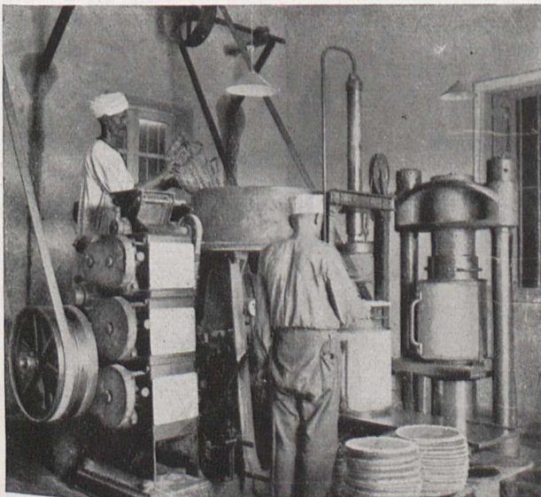
Bild 5. Hydraulische Seihpressen für Sesamsaat, von Arabern bedient
