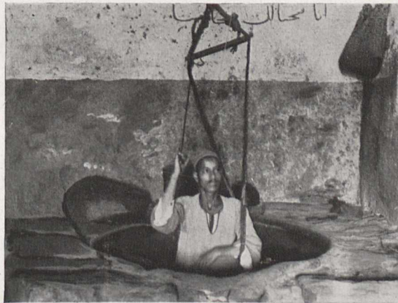
Bild 4. Der Sesambrei wird mit den Füßen durchgeknetet und gepreßt
