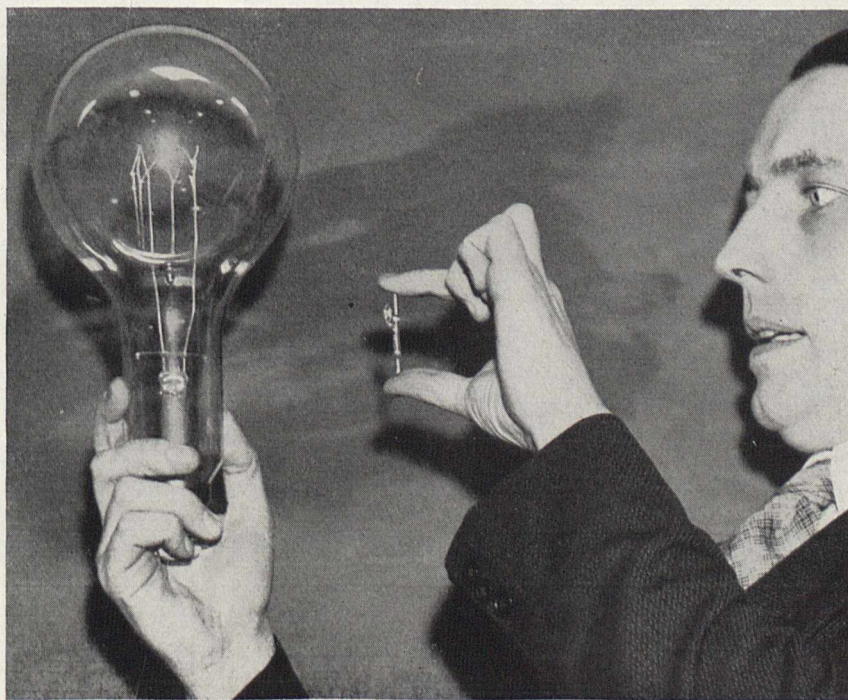
Bild 2. Größenvergleich zwischen der neuen und der bisherigen 1000-Watt-Lampe. Die neue Lampe übertrifft die alte um das Sechsfache an Lichtintensität.
