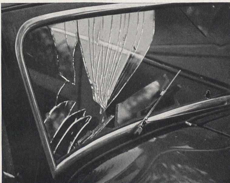
Bild 1. Zertrümmerte Windschutzscheibe aus gewöhnlichem Glas, gefährliche Dolche Fotomarten
