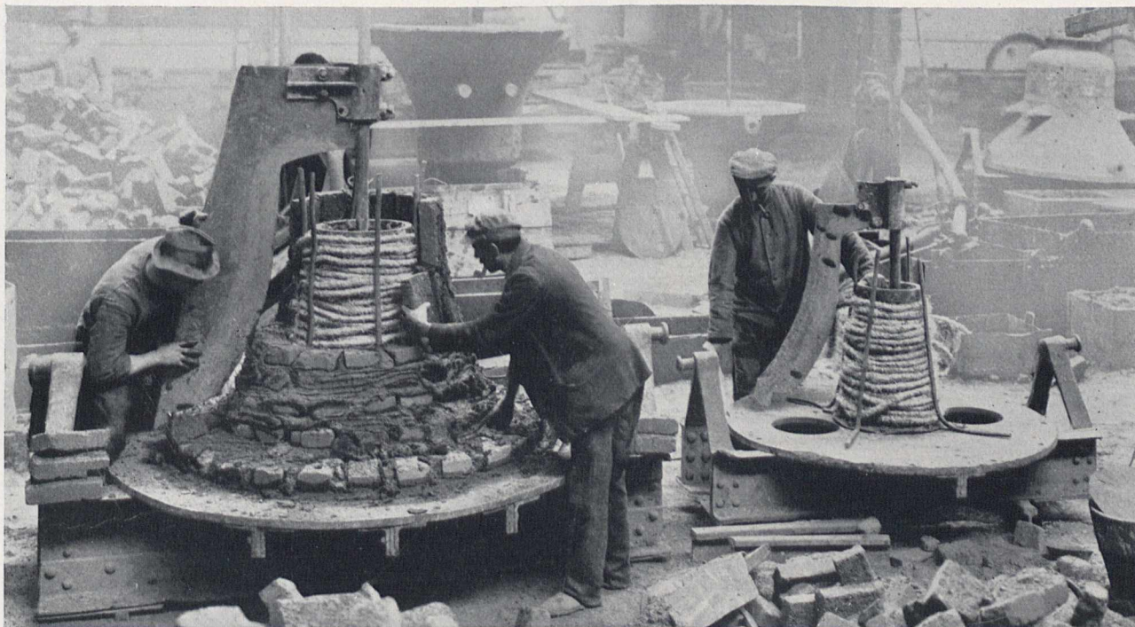
Bild 1. Das Formen des Glockenkernes
