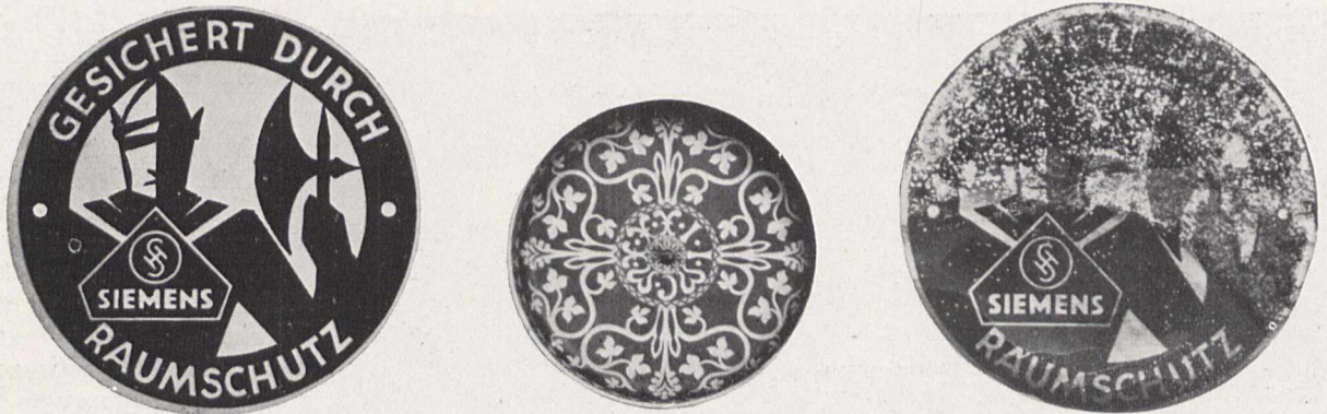
Links: Seo-Fot (Photographie auf Aluminium) vor dem Erhitzen. — Rechts: Nach dem Erhitzen: Das Aluminium ist geschmolzen, die Seo-Fot-Schicht blieb erhalten. — In der Mitte: Gepresste Schale mit Seo-Fot-Ornament. Durch die Pressung ist das Ornament nicht geschädigt.
