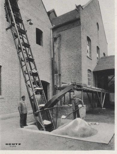
Bild 2. Das zerkleinerte Holz wird mit Sägespänen gemischt in einen Hochbehälter der Vergaseranlage geleitet
