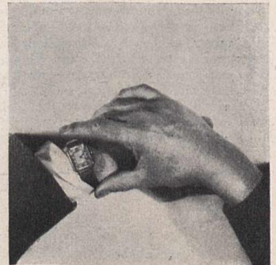
Bild 2. Bei Uhren verbürgt der neue Werkstoff wegen seiner großen Bruchfestigkeit längere Lebensdauer. Dies Glas schrumpft und verzieht sich nicht. Die Gläser sitzen deshalb immer fest in der Fassung.
