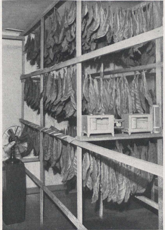
Bild 7. Blick in einen Begasungsraum von 30 cbm Inhalt. Auf dem Gestell sieht man auch einen selbst- schreibenden Temperatur- u. Feuchtigkeits- messer.
