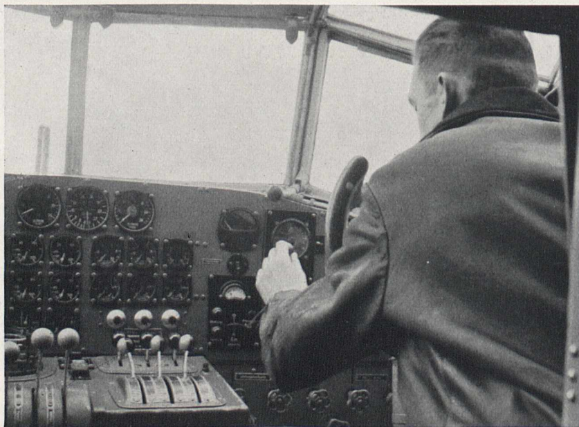
Bild 5. Das Instrumentenbrett. Der Führer bedient gerade den Kurvengeber. — Mit diesem Instrument kann das Flugzeug stufenweise in eine Kurvenlage bis zur Neigung von 30° gebracht werden. — Beim Kurvenflug werden durch dieses Instrument sämtliche Ruderflächen sinngemäß automatisch betätigt.
