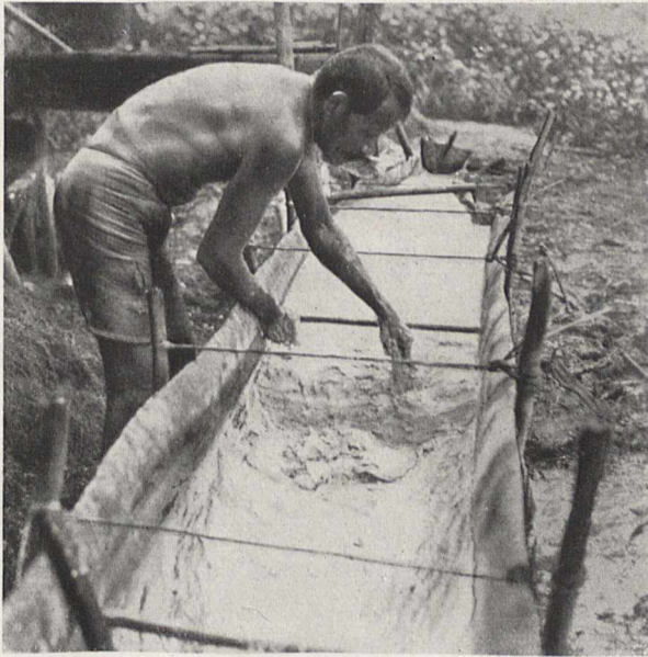
Bild 4. Das abgesetzte Sagomehl wird aus dem Absetztrog ausgestochen
