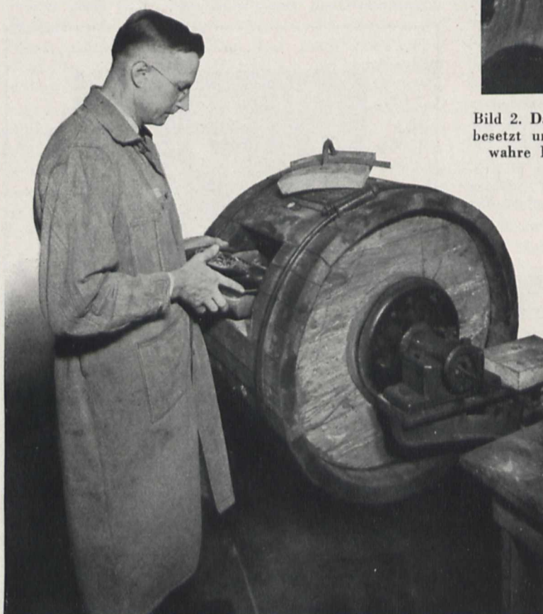
Bild 1. In dieser Prüftrommel werden Schuhe auf ihre Haltbarkeit geprüft
