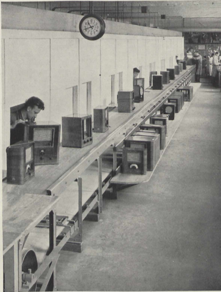
Bild 6. In den Kabinen links werden bei Siemens die auf dem laufenden Band ankommenden Empfänger geprüft
