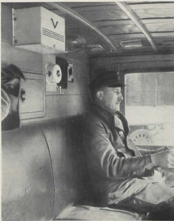
Bild 1. Auto-Signal-Anlage im Führerstand. V = Verstärker. — L = Lautsprecher.
