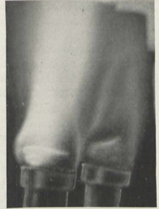
a b Bunsenflamme, durch Kochsalz gelb gefärbt a: in unmittelbarem Licht, b: durch ein Neophanglas gesehen
