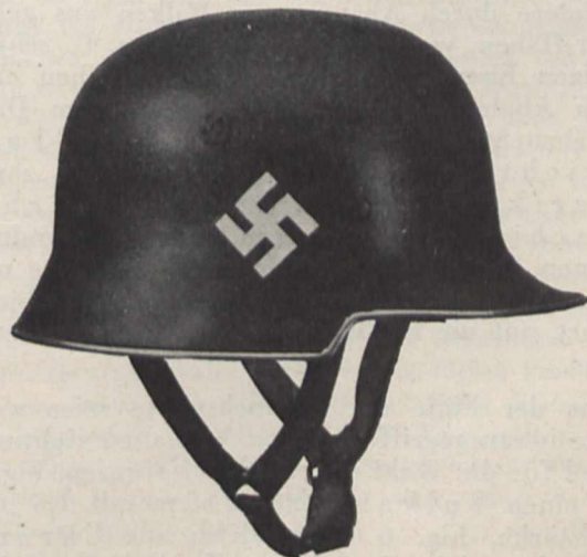
Fig. 7. Der neue zunächst für Preußen vorschrittmäßige Feuerwehrlhelm aus 0,8 mm starkem Chromnickelstahl oder einer 1,3 mm starken, vergüteten Leichtmetall-Legierung von 900 g Gewicht
