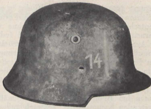
Fig. 6. Helm aus Chromnickelstahl mit 0,8 mm Wandstärke
