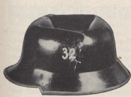
Fig. 5. Vulkanfiber-Helm mit 1,5 mm Wandstärke
