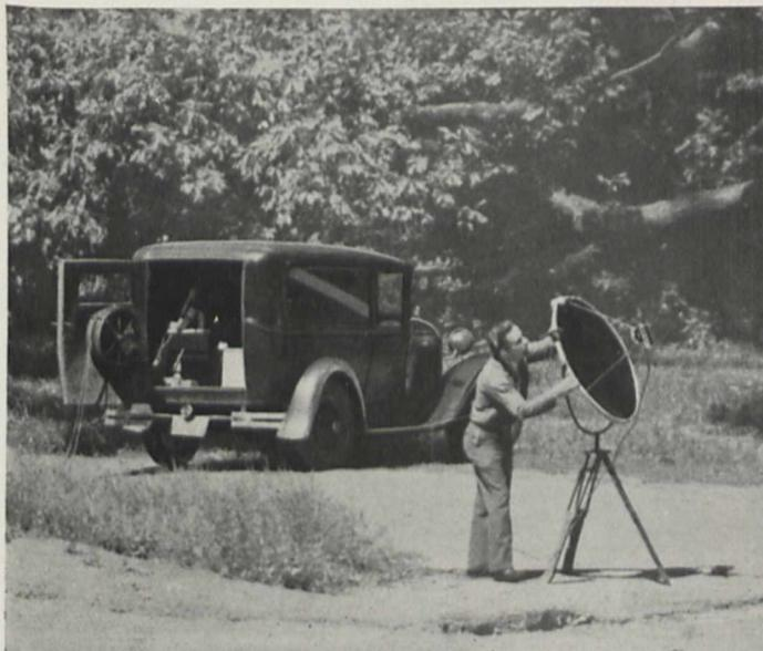
Fig. 3. Der „Tonsammler“ in Verbindung mit dem Aufnahmegerät im Auto
