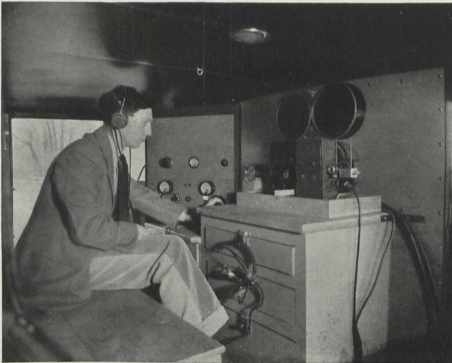
Fig. 1. Die Tonaufnahme-Apparatur eines Tonfilms von freilebenden Vögeln im Innern eines Motorwagens
