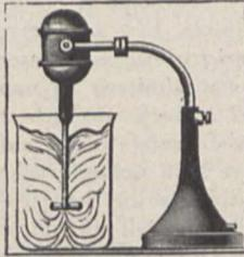
gelagert, so daß zusammen mit der Schwenkvorrichtung des Motors der Rührer jeder Gefäßform angepaßt werden kann. In dem gußeisernen Fuß ist ein stufenlos verstellbarer Regulierwiderstand angebracht, der die Möglichkeit bietet, die Tourenzahl der Rührwelle beliebig in den Grenzen von 5 bis 2000 Touren in der Minute einzustellen. Der Motor ist stark genug, um auch dickere Massen gut zu verarbeiten. Der Stromanschluß geschieht mittels eines Steckers an die Steckdose der Lichtleitung.
