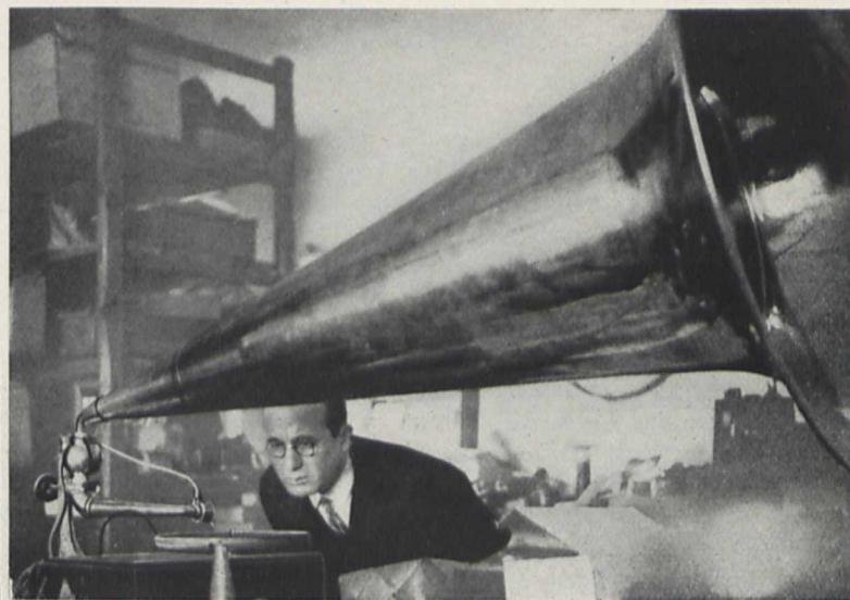
Fig. 3. Die Riesensprechmaschine im Laboratorium Schellhorns, die überaus lautstark war, mit Preßluft betrieben und vor der Erfindung der elektrischen Schallplattenverstärkung in großen Lokalen und Gärten verwendet wurde
