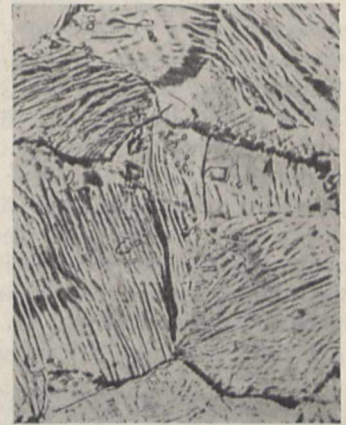
Fig. 2. Verformte Kristallite von Zinn
