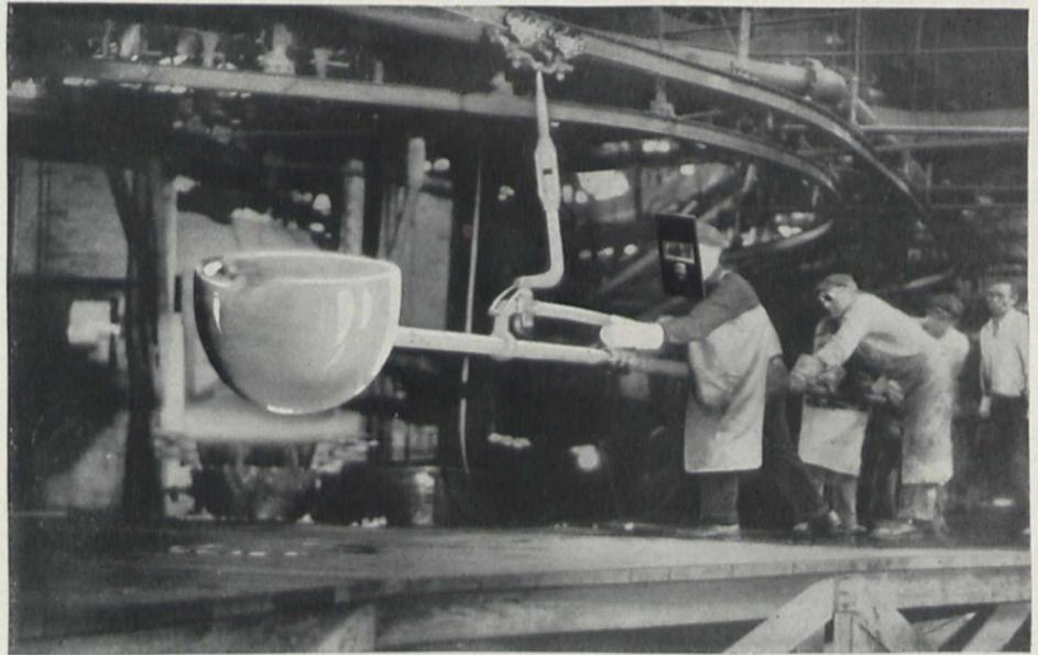
Fig. 2. Das geschmolzene Glas wird vom Schmelzofen in die Form gegossen mittels riesiger Löffel, die an Straßenbahnschienen hängen
