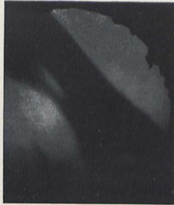
Fig. 3. Verkohltes Baumwollgespinnst, im Elektronenmikroskop 12100fach vergrößert
