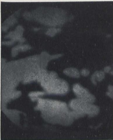
Fig. 4. 0,8  $\mu$  dünne Aluminium-Folie, im Elektronenmikroskop 7800fach vergrößert
