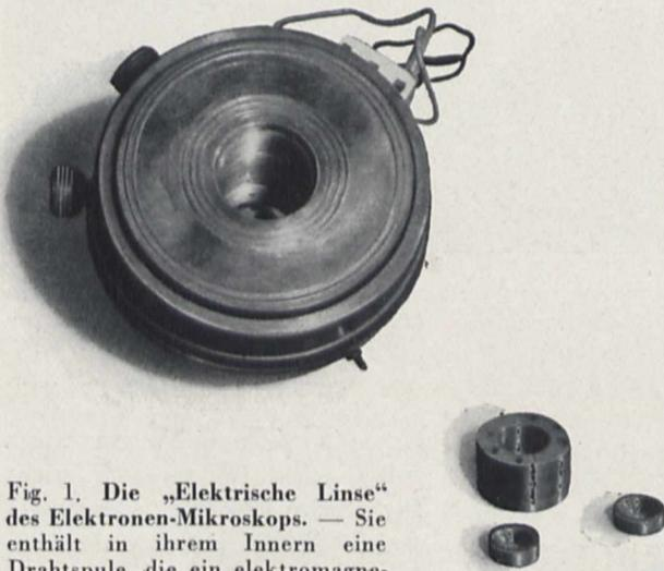
Fig. 1. Die „Elektrische Linse“ des Elektronen-Mikroskops. — Sie enthält in ihrem Innern eine Drahtspule, die ein elektromagnetisches Feld erzeugt, und dadurch die Elektronenstrahlen ebenso ablenkt, wie die geschliffene Linse die Lichtstrahlen.
