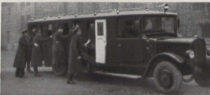
Fig. 5 links. Der Ueberfallwagen der Wiener Polizei mit der Radiokabine hinter dem Führersitz (Vgl. Fig. 3). Auf dem Dach die Antenne.
