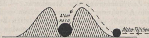
Der Atomkern hat sich durch seine elektrische Ladung gewissermaßen mit einem Schutzwall umgeben, über den das Alpha-Teilchen (Geschoß) hinwegkommen muß, um auf normale Weise den Kern zu zertrümmern
