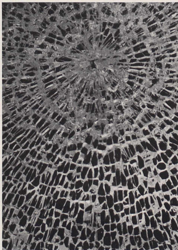
Fig. 2. Zerbrochenes Sekurit-Glas splittert nicht, sondern zerfällt in zusammenhängende Krümel Phot. Presse-Photo
