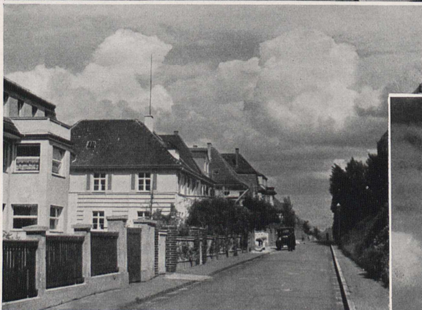
Fig. 1a und b. Straßensbild. — Oben: Ultrarot-Aufnahme. Unten: Aufnahme auf Film, der unempfindlich gegen Ultrarot. a (oben) auf Agfa-R-Film aufgenommen mit Blende 1:3,5 und Lifa-Filter Nr. 200c, \frac{1}{50} Sekunde Belichtungszeit, b) (unten) Aufnahme auf orthochromatischem Film mit Blende 1:5,6 und Gelbfilter Nr. 1, \frac{1}{100} Sekunde Belichtungszeit.
