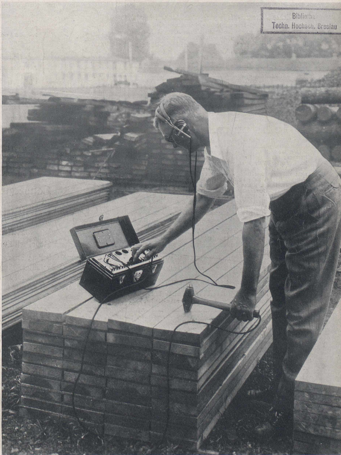
Feuchtigkeitsbestimmung von Holz durch Messung der elektrischen Leitfähigkeit Die Spitzen an einem Hammer, der mit einem elektrischen Meßinstrument verbunden ist, werden in das zu prüfende Holz geschlagen. Aus der Leitfähigkeit läßt sich die Holzfeuchtigkeit am Meßinstrument direkt ablesen.
