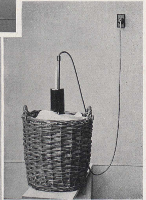
Fig. 3. Glasballons und größere Körbe werden während der Sterilisation gegen Wärmeverlust geschützt
