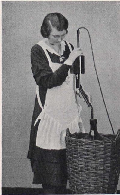
Fig. 1. Der elektrische Entkeimungsapparat für Korbflaschen und kleinere Fässer besteht aus 2 Gelenkelektroden mit Schutzkappe und ist an das Lichtstromnetz anzuschließen
