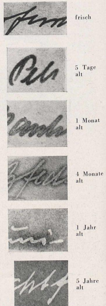
Fig. 4. Eisengallustinte in verschiedenen Alterungsstadien; chemisch in Ultraviolettlicht geprüft (2fach vergr.)
