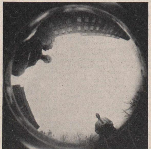
Fig. 6. Aufnahme mit einer wassergefüllten Lochkamera. Die Kamera war nach oben gerichtet. Fast die gesamte Halbkugel bis zum Horizont wird, teilweise verzerrt, abgebildet.
