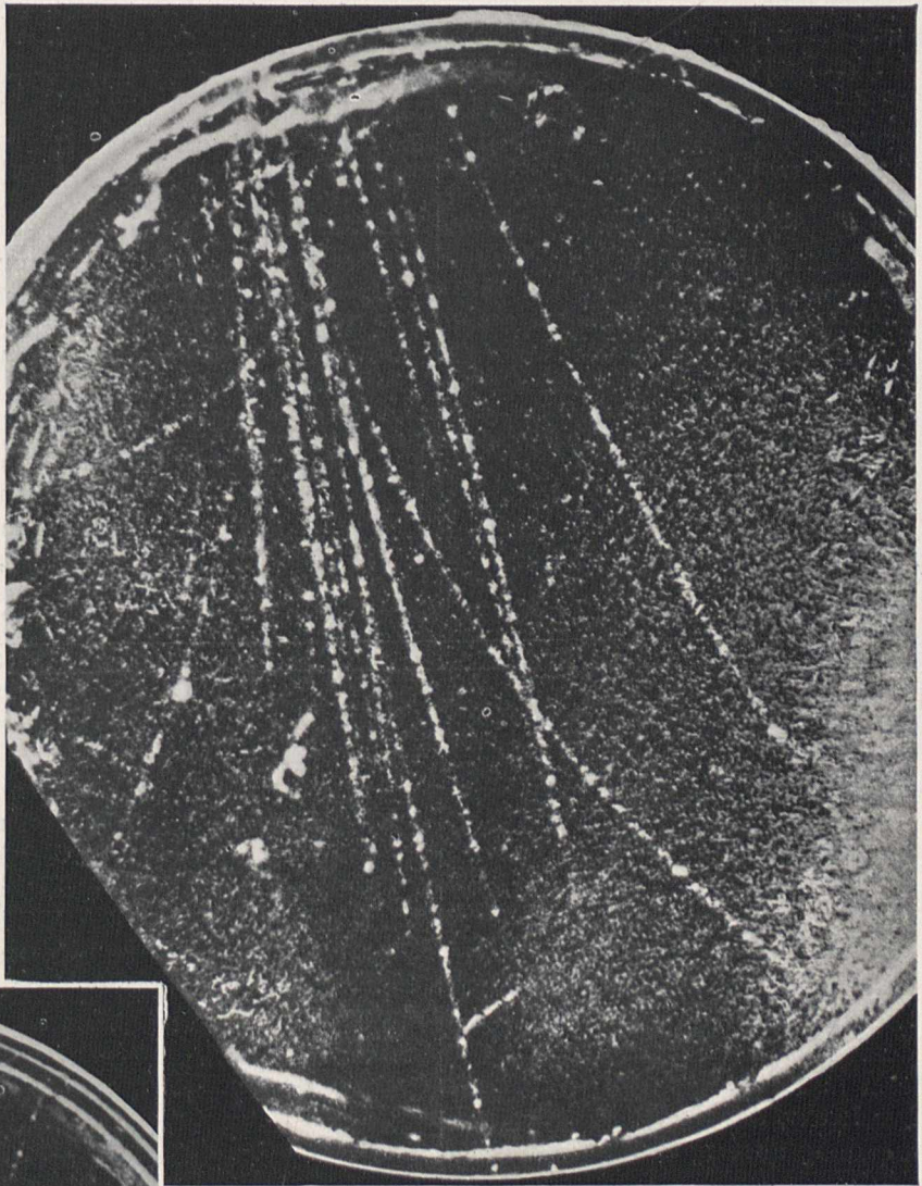
Fig. 3. Nebelfäden in der Wilsonschen Kammer, erzeugt von der durchdringenden Höhenstrahlung. Etwa 17 sehr rasche Elektronen hinterlassen ihre Nebelspur. Die meisten von ihnen besitzen eine solche Energie, daß sie trotz des Magnetfeldes geradlinig fliegen; ihre Energie entspricht einem Potential von mehreren Hundert Millionen Volt. Einige Nebelspuren aber sind nach links abgelenkt; sie müssen eine negative Ladung besitzen und dürften gewöhnliche Elektronen von hoher Energie sein. Die nach rechts umgebogenen Kurven sind durch positive Elektronen veranlaßt.
