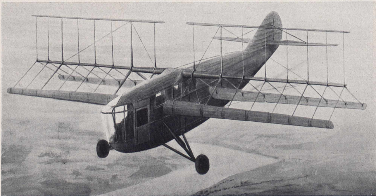
Fig. 2. Das Rohrbach-Flugzeug mit Umlaufflügel
