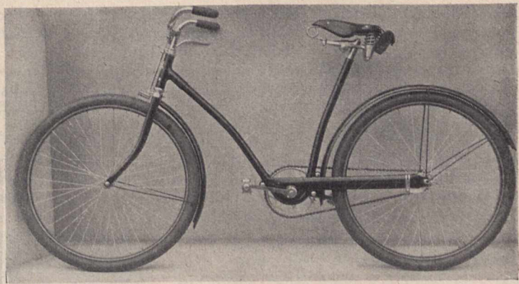
Fig. 9. Super-Elastikrad der FN-Motorenwerke (Entwurf Glaser)
