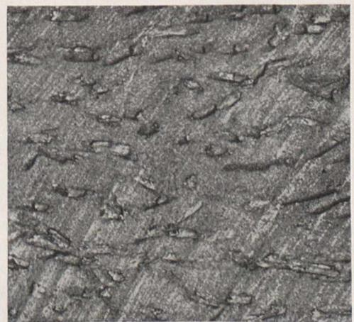
Fig. 5. Furniere (1,5 mm stark) aus einem Palmenstamm der Niederrheinischen Braunkohle. — Das obere Bild ist ein Längsschnitt in der Rindenzone des Stammes. — Die Querschnitte der die Rinde durchbrechenden Wurzeln erscheinen als elliptische Masern. — Das untere Bild ist ein Längsschnitt durch die Stammitte.
