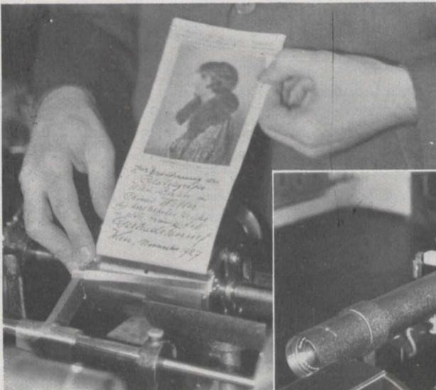
Fig. 8. Das Einspannen eines Bildes mit Unterschrift auf die Sendetrommel.
