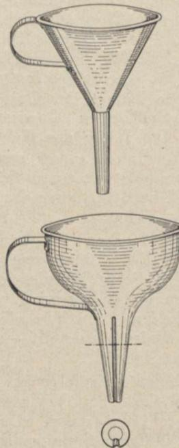
Fig. 10. Flüssigkeiten werden beim Zugießen in den Trichter oben überfließen, weil die durch die Flüssigkeit verdrängte Luft nicht wie bei dem Trichter unten durch eine Luftrille entweichen kann.
