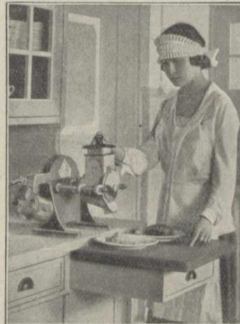
Fig. 1. Reibmaschine des Alexanderwerkes mit „Protos“ Küchenmotor.
