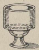
Fig. 5b. Eierbecher mit zu kleinen Füßen fallen leicht um.
