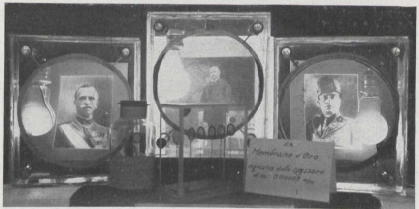
Fig. 7. Drei große Müllersche Goldmembranen von 180 mm Durchmesser und etwa  $\frac{1}{100\,000}$  mm Feinheit,
