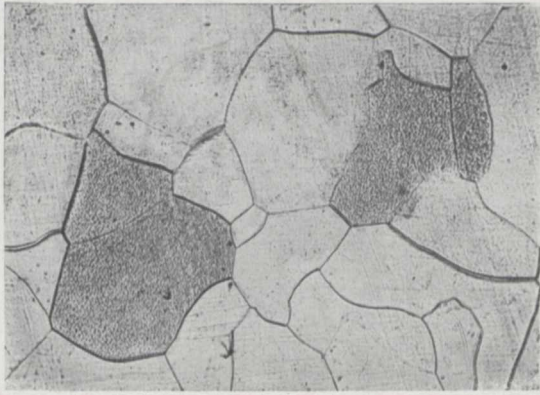
Fig. 1. Feingefüge von reinem Eisen; Gefügebestandteil Ferrit. (100fach vergrößert.)
