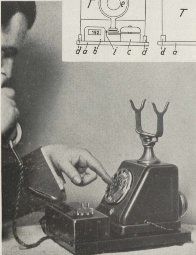
Fig. 2. Der Deckel des Gesprächszählers ist heruntergeklappt, die Nummernscheibe des Telephonapparates zum Wählen freigegeben
