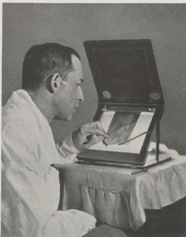
Fig. 3. Die letzte Druckfolie wird in den Paßrahmen eingelegt und durch Klammern festgehalten. Dieser trägt an seiner oberen Kante zwei parallele mit Löchern versehene, durch Flügelmuttern anziehbare Schienen.
