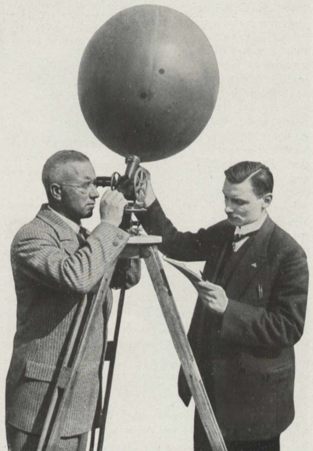
Fig. 2. Einvisieren des Theodoliten beim Pilotballonaufstieg
