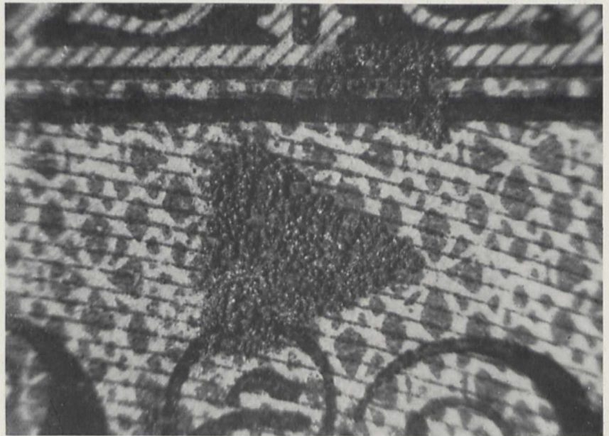
Fig. 7. Vergrößertes Stück der Banknote (Fig. 6) mit aufgespritztem Metall; die körnige Struktur desselben ist gut erkennbar.
