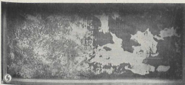
Fig. 5. Wirkung eines klopfenden Staubsaugers unter dem Teppich
