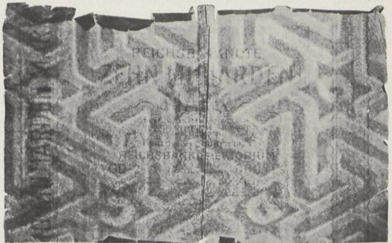
Fig. 4 (oben). Einseitig bedruckter Geldschein mit Grenzstrahlen durchleuchtet. Die Strukturen sind in beiden Fällen deutlich wahrnehmbar
