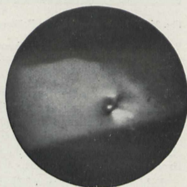
Fig. 2b falsche Gemengeaufbereitung
