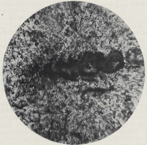
Fig. 6. Typischer Lochfraß bei metallischen Ueberzügen
