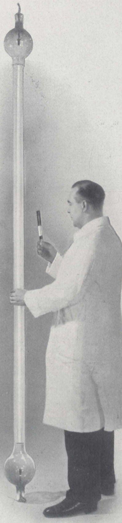
Fig. 2. Gasentladungsröhre für 100 Ampere; in der rechten Hand des Mannes eine Geißleröhre
