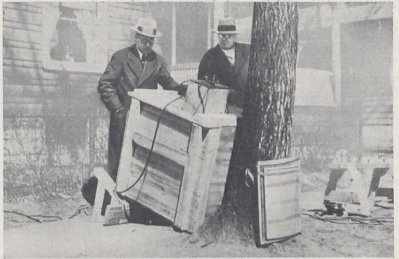
Fig. 1. Die Röntgen-Apparatur, mit der im staatlichen amerikanischen Forstdienst die Bäume auf ihren Gesundheitszustand durchleuchtet werden.
