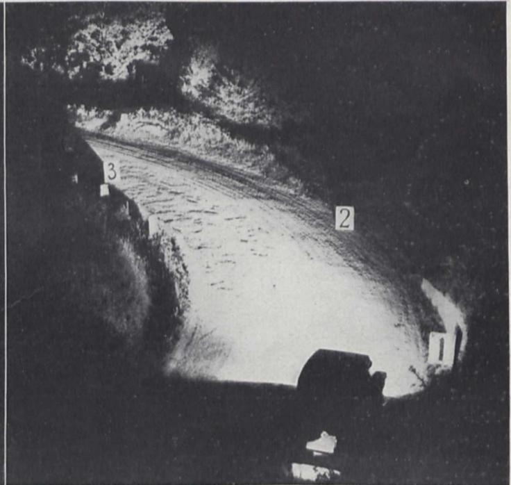
Fig. 3. Der Wagen an genau gleicher Stelle nach Inbetriebnahme des „Autolichtlenkers“. Die Kurve ist fast gleichmäßig erhellt, den großen Unterschied sieht man besonders beim Vergleich der aufgestellten Zahlentafeln.
