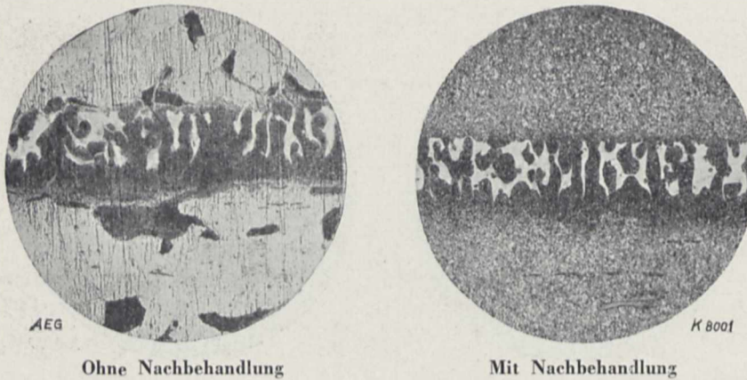
Fig. 3. SM-Stahl in Wasserstoff mittels Kupfer gelötet (vergrößert).
